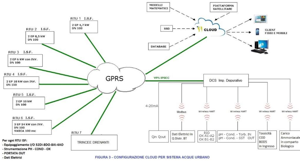
FIGURA 3 - CONFIGURAZIONE CLOUD PER SISTEMA ACQUE URBANO
