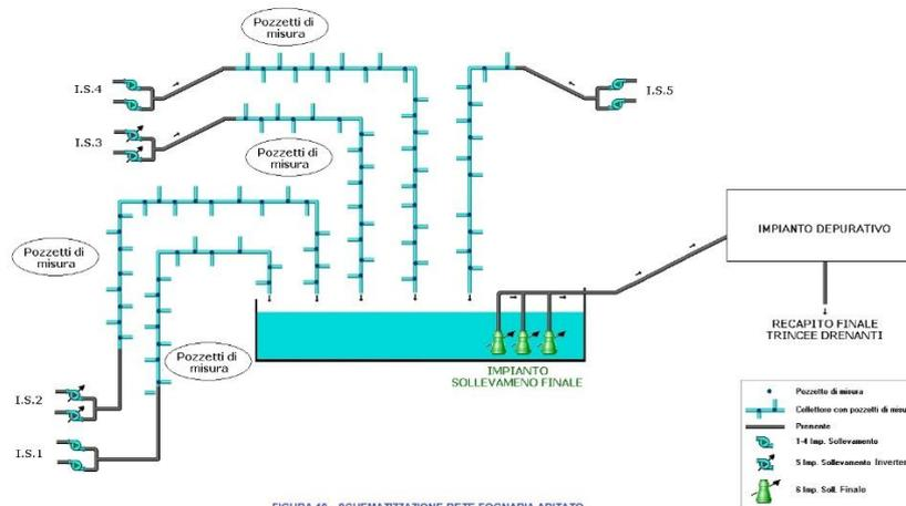
FIGURA 10 - SCHEMATIZZAZIONE RETE FOGNARIA ABITATO
