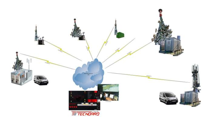
In generale una molteplicità di siti remoti di telecomunicazioni, costituiti da impianti elettrici, shelter, apparati radio, tralicci, antenne, sono gestiti localmente da una o più stazioni di telecontrollo che comunicano con la centrale operativa Tecnorad, attiva H24. Le unita remote, congiuntamente con la centrale operativa, monitorano lo stato degli impianti, gli assorbimenti elettrici e tutti i principali parametri operativi del sito in base alle indicazioni specifiche degli operatori.
