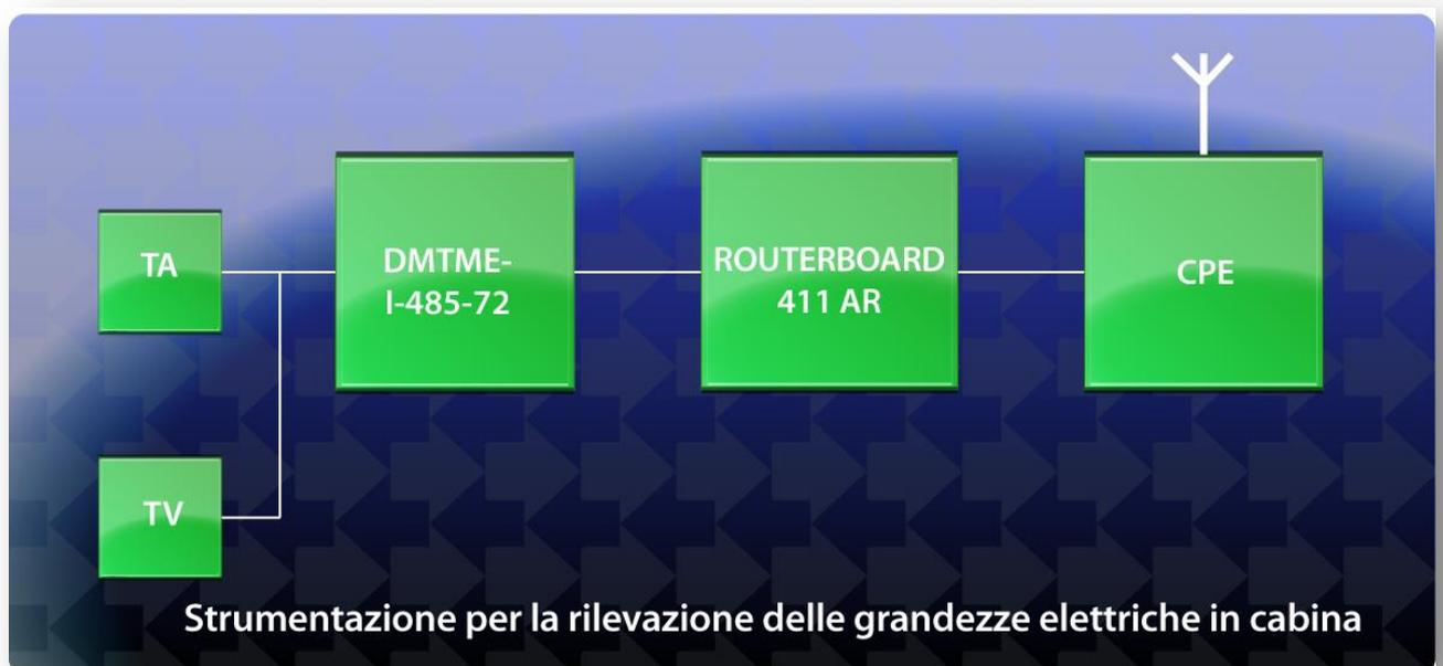
Figura 1 – Schema a blocchi dell'infrastruttura di acquisizione e trasmissione dati
