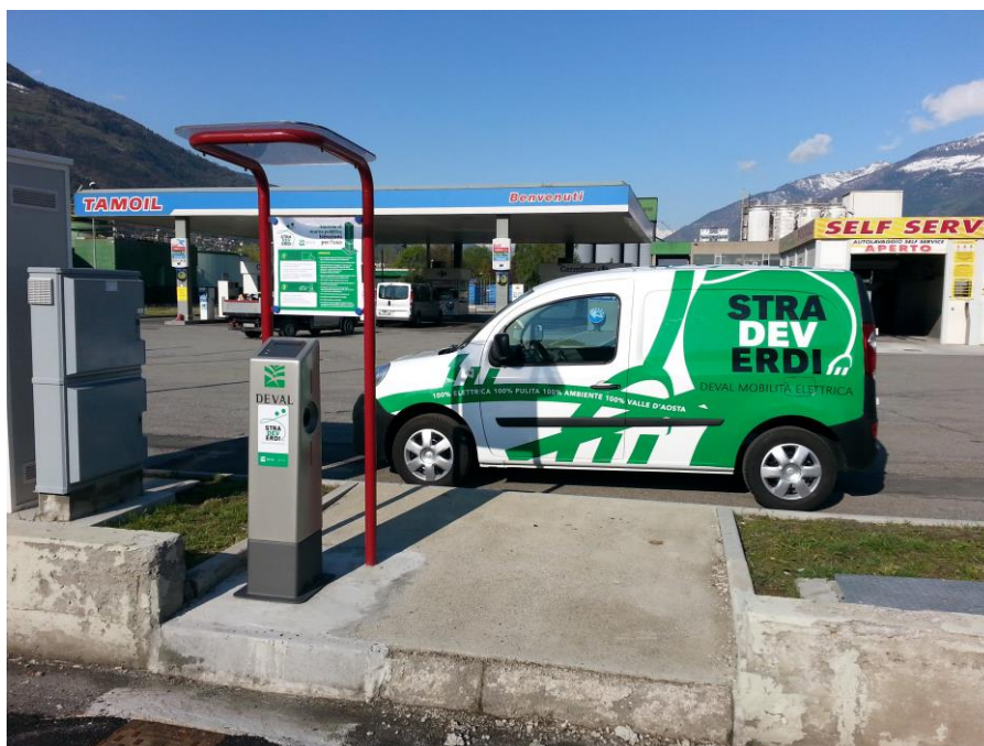
Figura 8. Furgone elettrico DEVAL e prima colonnina pubblica di ricarica, attivata nell'ambito del progetto Strade Verdi .
