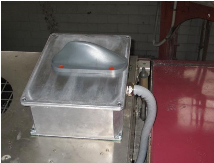
ANTENNA WIFI MONTATA SULL'IMPERIALE DEL TRENO
