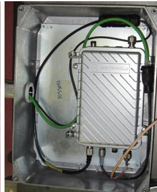
ANTENNA WIFI MONTATA SULL'IMPERIALE DEL TRENO
